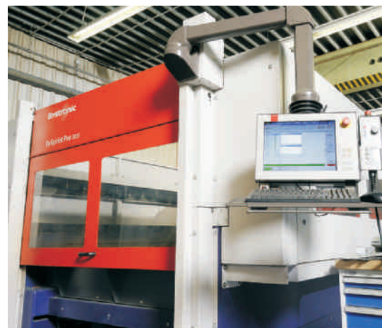
Die BySprint Pro ist ein Allrounder, der vor allem bei dünnen Blechen seine Stärken ausspielt. Dazu trägt auch das plasmaunterstützte Laserschneiden bei.
